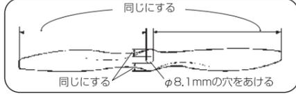
◆プロペラナットとプロペラワッシャを、プロペラ穴に差し込み14mmレンチを使って十分に締め付けます。
