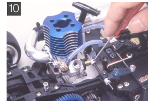
リンケージのロッドストップパーは確実に固定する。スペースが狭い場合は固定用ネジが他の部分に干渉することもあるので注意する。
