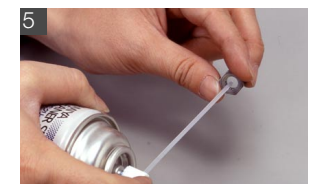
5 スプレー式のクリーナーでリコイル内のワンウェイベアリングを洗浄し、十分に乾燥させてから再びリコイルユニットを本体に装着すれば、本来の性能を回復できるはず。
