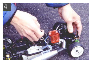
4 潤滑剤をエンジン内部に行き渡らせるため、リコイルを数回引いて作業は終了。潤滑剤の保護力により、エンジン内部のサビの発生を抑えることができる。
