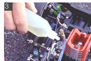
3 エアクリナーを外し、キャブレターの吸気孔からメンテナンス専用の潤滑剤を注入する。この作業の際はエンジン内部にホコリなどが入らないよう、気をつけること。
