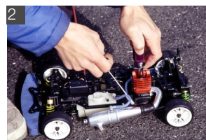
2 マシンにプラグブラスターを差し込み、リコイルを引いてエンジンを始動させる。オーバーチョークになった場合は無理にリコイルを引かず、対処すること。
