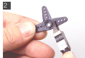
サーボホーンのアームの中で使用せず、なおかつ作動時に他の部分と干渉し、動きを妨げる可能性のある箇所を、あらかじめニッパー等で切り落としておく。
