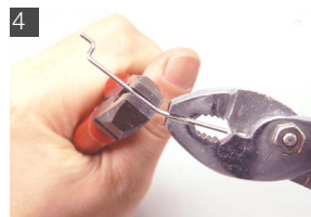
リンケージロッドを曲げる必要がある場合は、ベンチやプライヤー等を利用して正確に作業を行うのが、きれいにリンケージを仕上げるコツといえる。
