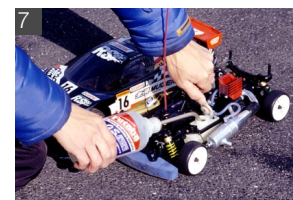
7 濃い目のニードルでは燃料の消費も早く、燃料タンクが空になる少し前には、キャブレター調整が薄くなるため、燃料がなくなる前にピットインして燃料補給を行う。
