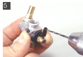
スロットルアームにリンケージを取り付ける際は、取り付け穴に使用するピアノ線がスムーズに通るよう場合によっては穴を広げておく。キツ過ぎずユル過ぎずが基本だ。
