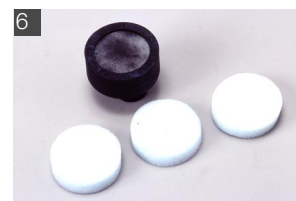
6 エアクリナーの汚れがひどくなるとエンジンの吸気にも影響を及ぼしてくる。交換用のフィルターも発売されているので、定期的に新品と交換しておきたい。
