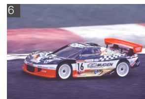
6 なるべくスロットルの開度を安定させて低速走行を行う。エンジンの種類や状態により走行時間は異なるが、2~3タンク走行を続けたら徐々にニードルを絞っていく。
