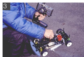
3 エンジンが始動したら、ベンチで十分に暖気運転を行う。メインニードルはスロットルを開けた際に、マフラーから白い煙が出るような濃い設定とする。
