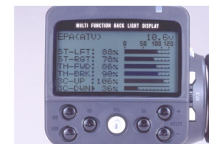
フタバ・メガテック 3PK など代表される高級プロポには EPA 機能が装備されているため、リンケージの自由度が広がる。
