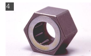
4 リコイルユニットの内部にはワンウェイベアリングが装備されている。このワンウェイがオイルや汚れで空回りしてしまうと、ローブを引いてもエンジンが始動しない。
