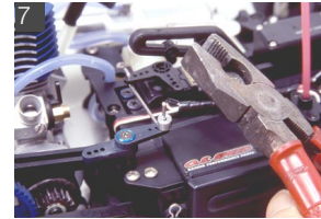
リンケージロッドの余った部分は作動の邪魔となったり、事故の元となる場合もあるので、ベンチやニッパー等で切り落としておくといだろう。
