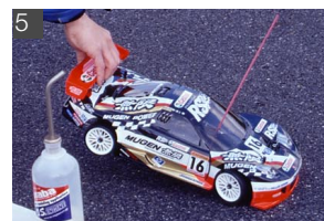
5 マシンにボディを被せてブレークイン走行を行う。濃いニードルのため低速走行となるが、オーバーヒートを防ぐためボディの穴開けなどにも気を配りたい。
