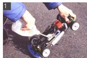
1 一日の走行を終えたら、まずはエンジン内の燃料を使い切る。タンクにまだ燃料が多く残っている場合には、フェューエルポンプである程度抜き取ってしまうといいだろう。
