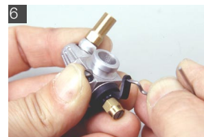
サイズの合わないピアノ線や無理な角度でスロットルアームにリンケージを取り付けると、作動に無理がかかりトラブルの原因になってしまうため注意したい。
