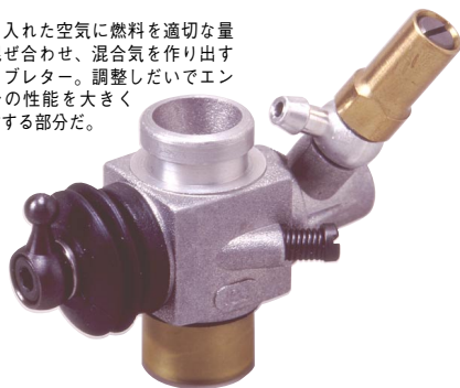
ニードルバルブの先端はテーパ状になっており、右の図のように締め込むと燃料の通り道が狭くなり、混合気が薄くなる。
