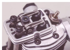
シリンダー上部には吸気用と排気用の2つのバルブがあり、ロッカーアームを介しそれぞれ独立して開閉される。
