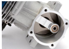
クランクシャフトクランプをはめるためには、ピストンを下死点にして、コンロッドをこの状態に。
