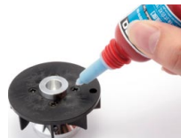
クーリングファンを固定するボルトにはネジロック剤も使用したい。
