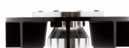
プーリーの表面からボルトが突出しているの見える。機体メーカーが指定しているボルトを使用する限りでは、こうした状態にはならない。適切なボルトを使用したい。
