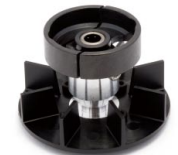
JR製の機体では、クラッチとファンが一体となったユニットをシャフトに固定。
