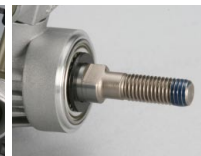
ドライブシャフトの先端にネジロック剤を塗り、ナットを確実に固定する。
