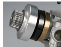
京商製ヘリの場合、クラッチハウジングはこのような状態になる。
