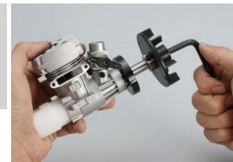
ドライブシャフトの先端にネジロック剤を塗り、ナットを確実に固定する。
