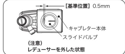
(注意) アイドル調整バルブ、及びメータリングニードルは工場出荷時に基準位置に調整済みですが、使用される燃料や気象条件などにより再調整が必要な場合があります。基準位置で運転されてみて良い結果が得られない場合は「キャブレターの調整」の項を参考に調整してください。
