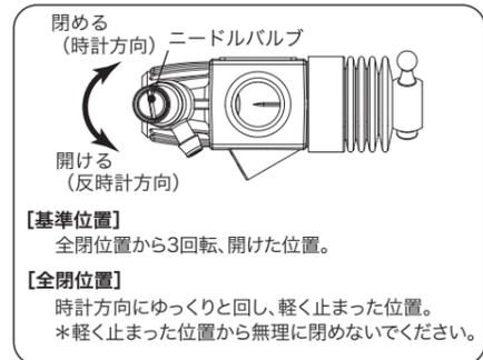
●アイドル調整バルブ 加速フィーリングを調整します。(調整範囲は±1回転以内としてください。)
