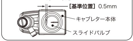
メータリングニードルは工場出荷時に基準位置に調整済みですが、使用される燃料や気象条件などにより再調整が必要な場合があります。
