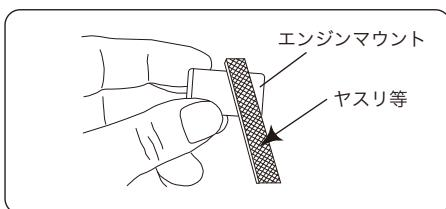
1. エンジン本体の取付け面(ビームマウントの下面)は完全に平面になるように加工されています。キットに付属されているエンジンマウントが平面でないと、クランクケースやシリンダーライナー、ベアリングなどを変形させ、エンジンの性能を十分発揮できないばかりでなくエンジンを破損してしまうことがあります。
