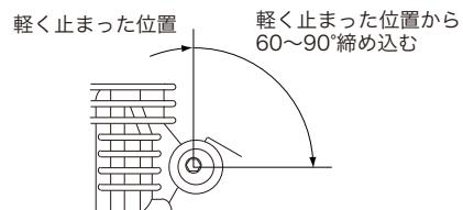
ボールリンクの向きを変える場合は、1.5mmの六角レンチを使用して、取付ねじをゆるめて行ってください。
