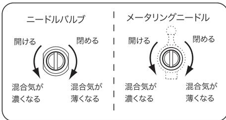
◆ 走行させる場所で一番長い距離が取れる直線(スロットル全開でまわれる大きなコーナーがある時はそれも含める)部分を2~3度スロットル全開で走行させてみて直線での速度を見上上で一度、車を手元に戻し、ニードルバルブを少し閉めて[一度に約15°]また同じ様に走行させてみてください。
