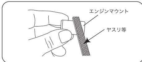
1. エンジン本体の取付け面 (ビームマウントの下面) は完全に平面になるように加工されています。キットに付属されているエンジンマウントが平面でない、クランクケースやシリンダーライナー、ベアリングなどを変形させ、エンジンの性能を十分発揮できないばかりでなくエンジンを破損してしまうことがあります。
