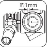
5. エンジンが始動したらタイヤを浮かせた状態で、プラグに通電したまま送信機のスロットルを動かして低速~中速を繰り返し、エンジンを暖めて下さい。この時、高速状態でエンジンを回し続けないようにしてください。
