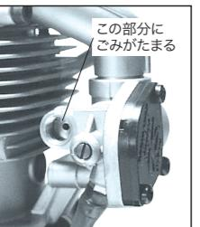
もしキャブレターの調子が悪い場合は、ニードルバルブホルダーを外し内部を掃除します。長い間使用していますと、この部分に綿くず状のごみがたまり、燃料がうまく流れずオーバーヒートしたり、時には焼き付きによってエンジンを破損することがあります。
