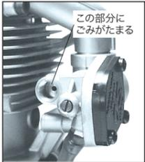
もしキャブレターの調子が悪い場合は、ニードルバルブホルダーを外し内部を掃除します。長い間使用していると、この部分に綿くず状のごみがたまり、燃料がうまく流れずオーバーヒートしたり、時には焼き付きによってエンジンを破損することがあります。
