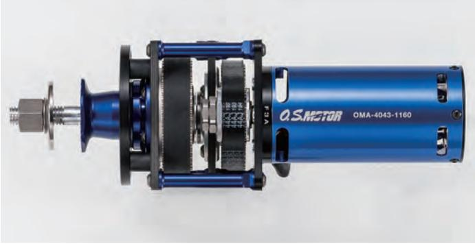
前モデルから減速比を6.73:1から7.03:1へ変更。172IIでは負荷が大きく回しきれなかった22インチサイズのプロペラに対応し、よりゆったりとした等速感のあるフライトを実現します。
