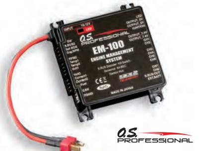
EM-100は大型ガソリンエンジンの各種制御を始め、テレメトリーセンサーの情報を最大で26個(※)のサーボに対してフィードバックミキシングが可能。プロユースのクオリティと豊富な制御機能を備えたマネジメントシステムです。
