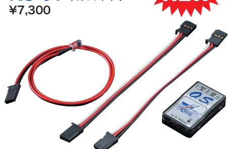
KS-01は、ガソリンエンジン用イグナイター電源のON/OFFを送信機側から制御を可能にする装置です。予備の空きスイッチチャンネルに接続して使用できます。また、イグナイター電源操作以外でも、飛行機、ヘリコプターなどの機体のライティング(LED)やスマート用ポンプの電源操作にも使用可能です。
