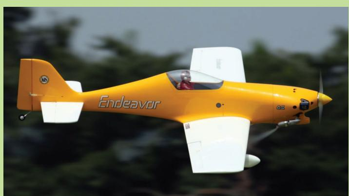
O.S.FS α-81-PをK&S社のスケール・エアレーサー、エンデバーに搭載。鋭いターンからの立ち上がりでも全くエンジンにストレスを感じさせない、ポンプ搭載エンジンならではの飛びを実現する。高速の伸びも申し分ないものであった。
