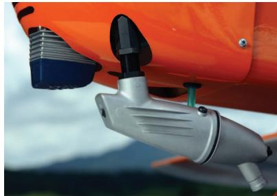
グレートブレーンズの最新モデル、リアクターには純正のインカウルマニホールドを装着することでスッキリと搭載できる。
