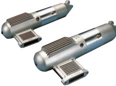
サイレンサー内部に二重バッフル(遮蔽板)と延長室を設け、容量のボリュームアップと多室化を計ることにより、パワースロスの最小化と低騒音を実現しました。
