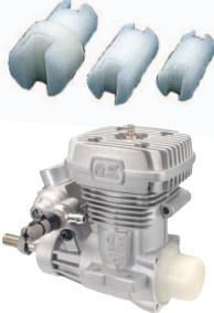
カー用エンジンのフライホイル、ヘリコプター用エンジンのクーリングファン、ボート用エンジンのフライホイル等をクランクシャフトへ取り付ける場合、クランクシャフトを固定し、共回りを防ぎ確実にジョイントやパイロットシャフトを締め付けることができます。エンジニアリングプラスチック（ポリアセタール樹脂）製のため耐油性、耐久性が高くしかも、エンジンのクランクケースやコンロッド、クランクシャフトに傷をつけることもありません。
