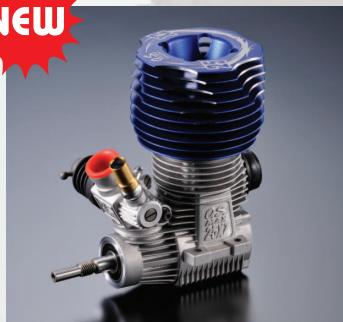
新開発0.25cu.in.のブロックは、トラギーはもちろん、1/8バギーにも搭載可能なコンパクトなサイズ。Tタイプヘッドを使用し、ホットタイプのT-P3を指定プラグとしています。ダブルアジャストキャブレターにはレデューサーが付属。
