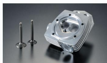
4ストロークエンジンの最重要パーツであるシリンダーヘッドは、その材質を変える設計において、バルブシートを無くすことにより給排気口の位置の自由度を拡大し、より性能を追求することが出来るようになりました。
