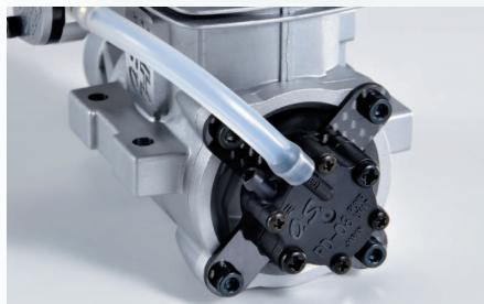
リヤカバー部にカーボンプレートで取り付けられる仕様は、エンジン本体が発する振動や熱の伝達防止を考慮しての設計です。そのためMAX-91HZ-PSでは、常時安定した燃料供給が可能となっています。
