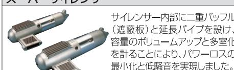
サイレンサー内部に二重パッフル(遮蔽板)と延長パイプを設け、容量のボリュームアップと多室化を計ることにより、パワーロスの最小化と低騒音を実現しました。
