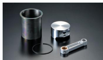
ワンランク上のパワーを狙うため全てのパーツが見直されました。例えばピストンリングは従来のものに比べ厚みと幅をまた断面形状をも見直し、フリクションロスを下げる事が出来ました。またH型断面を持つコンロッドは重量を増やさず、排気量アップに対応した強度を確保しています。
