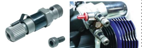
このニードルを装着することにより特にホバリング付近の混合比をより細かく調整出来るようになり全スロットル域でより安定した運転を実現します。
