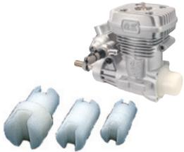
カー用エンジンのフライホイール、ヘリコプター用エンジンのクーリングファン、ボート用エンジンのフライホイール等をクランクシャフトへ取り付けの場合、クランクシャフトを固定し、共回りを防ぎ確実にジョイントやパイロットシャフトを締め付けることができます。エンジンアリングプラスチック（ポリアセタール樹脂）製のため耐油性、耐久性が高くしかも、エンジンのクランクケースやコンロッド、クランクシャフトに傷をつけることありません。
