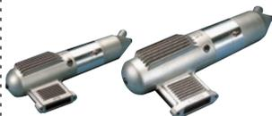
サイレンサー内部に二重パッフル(遮蔽板)と延長パイプを設け、容量のポリウムアップと多室化を計ることにより、パワーロスの最小化と低騒音を実現しました。
