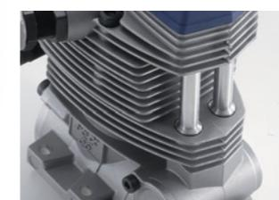
エンジンのクランクケース内部にリークしたオイルは、既存モデルのようにブリーザーニップルからエンジンの外に排出するのではなく、ブッシュロッドパイプの中を伝ってヘッドに導かれ排気と共に排出されます。
