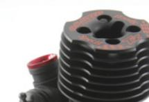
ヒートシンクヘッドには、既存のアルミと比較し約40%も軽量になるマグネシウム素材を採用。これによりシャシーの低重心化にも大きく貢献。(office ZPI製)
