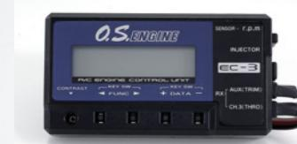
インジェクタからの燃料噴出量をコントロールするEC-3は、文字通りエンジンの運転を全て司るFS-200S-FIの頭脳と呼べる部分です。加えてフライト中の最高回転数をメモリするなど、フライトデコード機能も備え、競技会での性能発揮にベストを尽くします。
