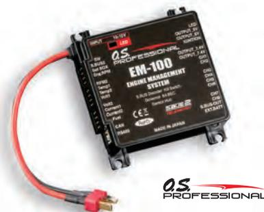
EM-100は大型ガソリンエンジンの各種制御を始め、テレメトリーセンサーの情報を最大で26個(\*)のサーボに対してフィードバックミキシングが可能。プロユースのクオリティーと豊富な制御機能を備えたマネジメントシステムです。
