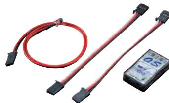
KS-01は、ガソリンエンジン用イグナイター電源のON/OFFを送信機側から制御を可能にする装置です。予備の空きスイッチチャンネルに接続して使用できます。また、イグナイター電源操作以外でも、飛行機、ヘリコプターなどの機体のライティング(LED)やスモーク用ポンプの電源操作にも使用可能です。
