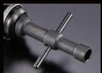
パイロットシャフトに確実にフライホイールを取り付けるためには、クラッチレンチが欠かせない存在。可動式のハンドルで、しっかりとクラッチを固定することが可能です。またアジャスターは、センタックスタイプのクラッチを細かく調整できます。
