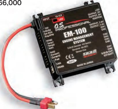
EM-100は大型ガソリンエンジンの各種制御を始め、テレメトリーセンサーの情報を最大で26個(※)のサーボに対してフィードバックミキシングが可能。プロコースのクオリティーと豊富な制御機能を備えたマネジメントシステムです。
