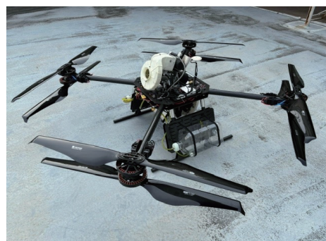
メインフレーム上下に GT33REU を 1 機ずつ搭載
