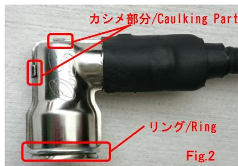
さい。リングが変形している場合や、紛失している場合は交換 (74002200 PLUG CAP SET) してください。
