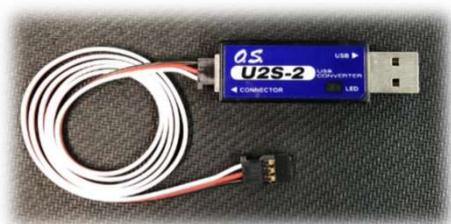
【シリアル信号変換器】型式:U2S-2(EC-2#用)
