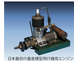
日本最初の量産模型飛行機用エンジン 1936 O.S. TYPE-1 <PIXIE> 1.66c.c.
