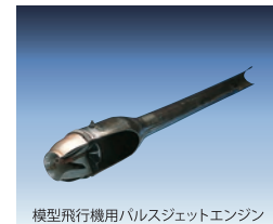
模型飛行機用バルスジェットエンジン 1952 JET-II <CUT MODEL>
