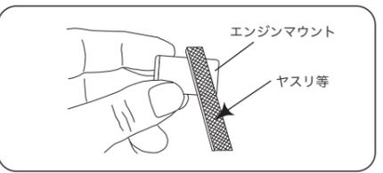
1. エンジン本体の取付け面(ビームマウントの下面)は完全に平面になるように加工されています。キットに付属されているエンジンマウントが平面でないと、クランクケースやシリンダーライナー、ベアリングなどを変形させ、エンジンの性能を十分発揮できないばかりでなくエンジンを破損してしまうことがあります。
