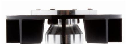
プーリーの表面からボルトが突出しているのが見える。機体メーカーが指定しているボルトを使用する限りでは、こうした状態にはならない。適切なボルトを使用したい。
