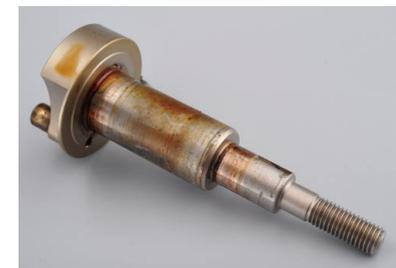
過熱で錆びが出るのは、フライパンの底が焦けているのと同じ理屈だ。
