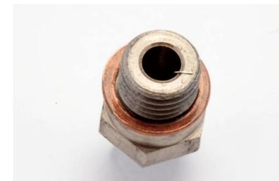
オーバーヒートによりフィラメントが溶け落ち、一部だけ残った状態。
