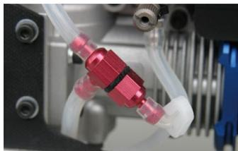
燃料フィルター周辺もトラブルの多いところだ。接続部やフィルター自体に亀裂があれば燃料が空気を吸むことに。
