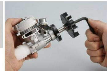
京商製ヘリの場合、クラッチハウジングを固定するには一度クーリングファンを取り付ける。ここでの締め付けが肝心だ。
