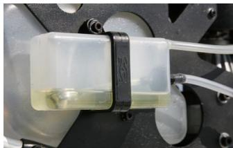
燃料タンク内のシリコンチューブは常にニトロに漬かっているため劣化も早い。最悪の場合、燃料流路を閉ざす。
