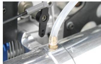
ニップルに接続する部分は高温になるため劣化しやすい。チューブが弾力を失うと、圧で抜け落ちる可能性も高い。
