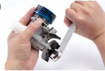
エンジンにクランクシャフトクランプを装着し、フライホイールレンチを使用して、ファンをナットで締め付ける。
