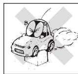
6. エンジンが暖まったらプラグブースターを外して走行させます。走り出し直後、中速付近で止まってしまう場合は混合気が濃い状態(吸い込む空気に対して燃料が多い)なので、ニードルバルブを15°~30°閉めてください。それでも止まってしまう場合は、メータリングニードルを15°~30°閉めてください。エンジンが止まらずに走行出来る状態で1タンク(燃料タンク1杯分)走行させてください。
