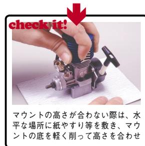
マウントの高さが合わない際は、水平な場所に紙やすり等を敷き、マウントの底を軽く削って高さを合わせ
