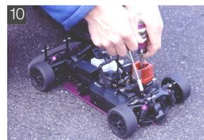
10 プラグブースターでプラグをヒートさせながら、リコイルスターターを引き、エンジンを始動させる。手首のスナップを利かせて最初に軽く力を入れるのがコツ。
