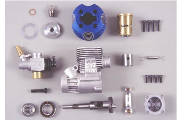
ことでクランクケース内で加圧された混合気が掃気ポートが開き燃焼室内へ流れ込む行程を「掃気」、続いてピストンが上がることで燃焼室内で密閉された混合気がピストンに圧縮されると同時に、クランクシャフトの吸気孔が開いて新しい混合気がシリンダーケース内へ流れ込む行程を「圧縮」、さらに燃焼室内で圧縮された混合気がプラグで点火され、ピストンを下に押し下げる「爆発」、最初の掃気行程とともに入ってくる新しい混合気に押し出される形で、排気ポートから燃焼したガスが排出される行程を「排気」といい、この4つの行程の繰り返しでエンジンを回転させているのです。
