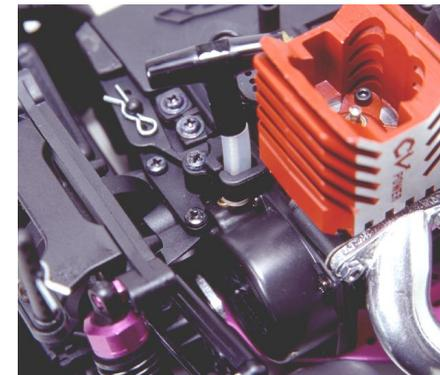
トラブルに見舞われた際には、リコイル部分を一度エンジンから取り外し、内部のワンウェイを洗浄するといでしょう。ただし、リコイル分解の際にはスプリングの飛び出しに十分注意し、ユニット全体をまっすぐ引き抜くようにして下さい。
