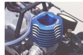
オプションで用意されている大型ヒートシンクヘッドは、高回転域の多用によるオーバーヒートを抑えるのに効果的だ。
