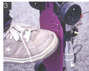
ツーリングカーなど箱型のボディが装着されるタイプは、とっさの場合フライホイールを靴の先で止めるのが確実な方法といえる。
