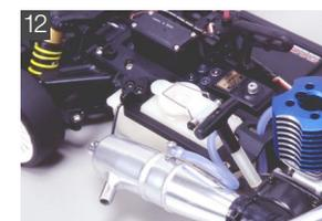
これでエンジン及び周辺機器の取り付けとパイピングが終了。走行前には再度ネジの増し締めを行い、締め込み具合を確認しておく。
