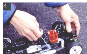
4 潤滑剤をエンジン内部に行き渡らせるため、リコイルを数回引いて作業は終了。潤滑剤の保護力により、エンジン内部のサビの発生を抑えることができる。
