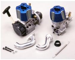
エンジンの性能を十分に引き出し、なおかつ出力特性に味付けを行えるマフラーやマニホールドの排気パーツは、クラッシュで変形したり、ガスケットが切れたり緩んだりして排気漏れを起こした場合、パフォーマンスが低下してしまう。メンテナンス時はガスケットやマニホールドスプリングの状態もチェックしよう。
