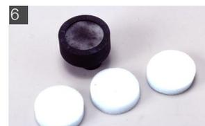
6 エアクリナーの汚れがひどくなるとエンジンの吸気にも影響を及ぼしてくる。交換用のフィルターも発売されているので、定期的に新品と交換しておきたい。
