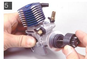
クラッチベルを取り付けた後はベルを指で回し、クラッチシューに干渉せず軽く回るようならOKだ。
