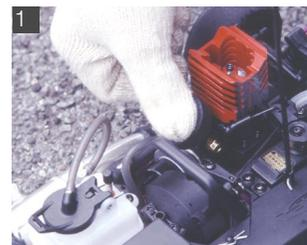
キャブレターの吸入口部分であるエアフィルターを指で押さえ、エアの吸入を止めてエンジンを停止させる方法は、安全かつ確実。
