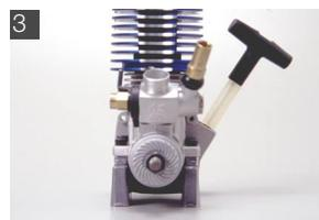
マウントを取り付けたら水平な場所で高さをチェックし、斜めに取り付けられていないかどうかを確認する。
