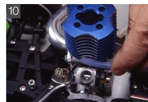
燃料チューブをエンジンに取り付ける。エンジンヘッドにチューブが干渉する場合は、ニップル(インレット)の向きを変えて対応する。
