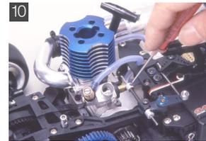
リンケージのロッドストップは確実に固定する。スペースが狭い場合は固定用ネジが他の部分に干渉することもあるので注意する。
