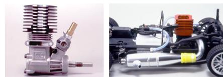
クランクケースの側方に排気口を設ける方式。R/Cプレーン用にルーツを見る一般的なスタイルで、リコイルスターターやマフラーを取り付けやすいというメリットを持つ。
