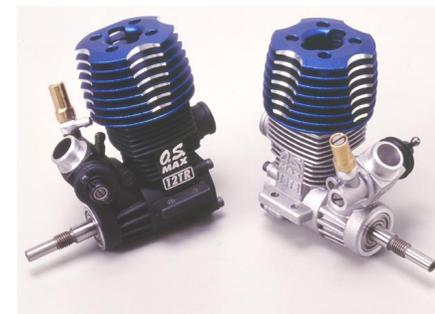
タイプとなり、ニードル調整もシビアとなってきます。また燃焼室内の圧縮率が高い分、爆発力も大きくなるため、単純に同じ条件で比較するとプラグの劣化もノーマルヘッドより早いといえます。しかし、ターボプラグ自体もノーマルプラグよりリーチが長く、放熱効果の高いつくりとなっていますので、21 や 15 クラスのエンジンと比較して爆発力の少ない 12 クラスエンジンでは、P6 プラグを基本としたニードルセッティングが効果的といえるでしょう。
