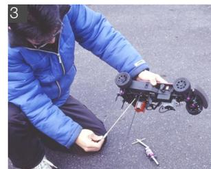
外部に排出される燃料が顔などにかからないよう、マシンを逆さに向けた状態でリコイルを数回引いて、燃焼室内の余分な燃料を抜く。
