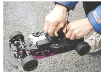
実際に走行させ、メインニードルを8割ほど合わせる。その後アイドル調整とスローを再調整し、さらにメインの最終調整を行う。
