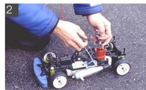
2 プラグをヒートさせ、エンジンを始動して残っている燃料をすべて燃焼させる。これがエンジン内部に残った燃料を使い切る、最も確実な方法といえる。
