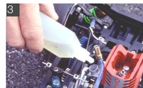
3 エアクリナーを外し、キャブレターの吸気孔からメンテナンス専用の潤滑剤を注入する。この作業の際はエンジン内部にホコリなどが入らないよう、気をつけること。
