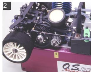
クラッチベルの位置を基準とし、ボックスに目印をつけた例。工夫次第でさらに便利になるのがスターターボックスの特徴だ。
