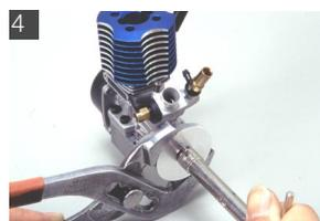
フライホイールをエンジンに固定する際には、大型のプライヤー等でしっかりとホルドし、パイロットナットを強く締め込む。
