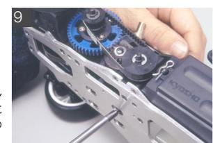
バックラッシュを確認した後、シャシーにエンジンを取り付ける。走行中に緩まないよう、しっかりとネジを締め込む。
