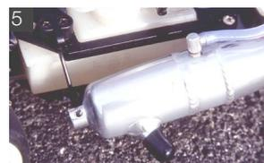
5 マフラー内部に残った油分が外に出てくるのを防ぐため、マフラーにキャップを装着しておくのも一つの方法。次回に走行させる際の直前には忘れずに取り外すこと。
