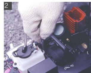
燃料タンクからキャブレターにつながっているチューブを指で押さえ、燃料の流れを止めてエンジンを止める方法もいいだろう。
