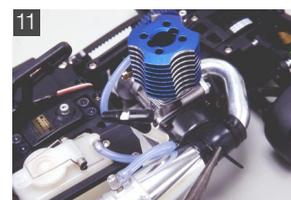
マニホールドにマフラーを取り付ける。ジョイントチューブは装着した後、隙間がないようにストラップでしっかりと固定する。
