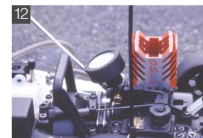
12 エンジンが暖まった後、キャブレターのアイドルリング調整ピスで、ニュートラルでクラッチが繋がらず、なおかつエンジンが止まらない位置に回転数を調整する。
