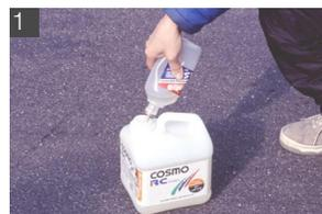
1 まずはフューエルポンプを使って燃料をポンプに入れる。ポンプを握りながら先端を燃料の中に入れ、手の力を弱めるとポンプの中に燃料が入ってくる。
