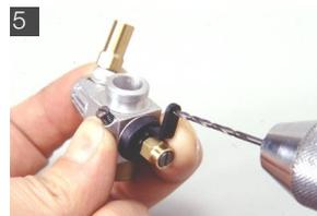
5 スロットルアームにリンケージを取り付ける際は、取り付け穴に使用するピアノ線がスムーズに通るよう場合によっては穴を広げておく。キツ過ぎずユル過ぎずが基本だ。
