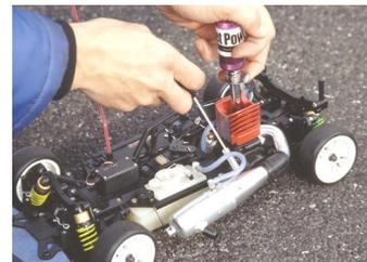
スロットルバルブが開いているのを確認し、エンジンを始動させる。正しい始動方法やプラグの確認は後のページで紹介する。
