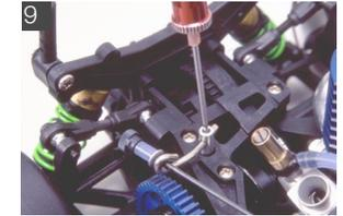
ブレーキのリンケージ部分もスムーズな作動を心掛け、スロットルのニュートラル時にブレーキを引きすぎないように注意して効き具合を調整する。
