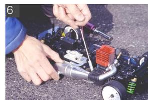
6 チョークボタンが装備されていない場合は、キャブレターの吸入口かマフラーの出口を押さえ、リコイルを引くと燃料がキャブレターに送られる。
