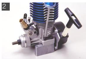
エンジンマウントを取り付ける際には、水平な場所で4本のネジを少しずつ均等に、対角線上に締め込んでいく。
