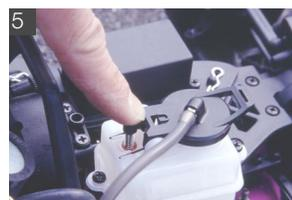
5 燃料タンクに装備されたチョークボタンを押し、燃料をキャブレターに送り込む。チューブに燃料が流れていくのを確認したら、さらに2、3回ボタンを押しておく。
