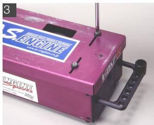
スターターボックスは電源にバッテリーを使用する。当然電圧が落ちるとパワーも低下するので注意したい。
