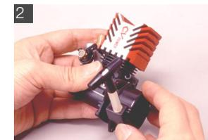
2 スプリングが飛び出して目などに当たると大怪我の恐れもあるため、注意しながら反時計回り（左方向）にリコイルユニットを回しながら、ケースからまっすぐ抜き取る。
