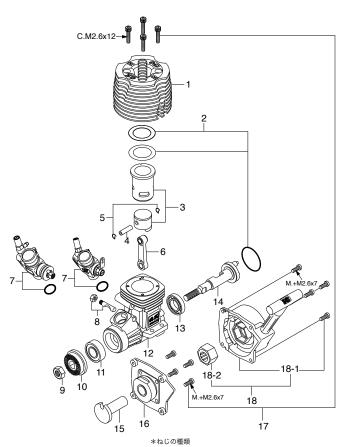
C…キャップスクリュー B…パインドねじ M…丸平ねじ F…皿ねじ N…なべねじ S…セットスクリュー
