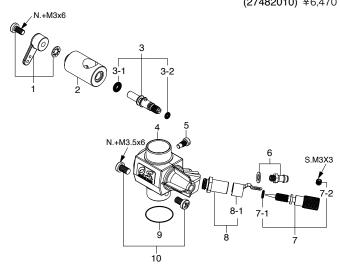
C…キャップスクリュー B…バインドねじ M…丸平ねじ F…皿ねじ N…なべねじ S…セットスクリュー
